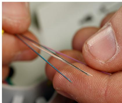
Pour être protégé, le fil de fibre optique est enrobé de résine, puis d'une gaine qui sera polissée et colorisée. Ces tubes de fibre sont ensuite disposés en rouleaux de 50 km.
